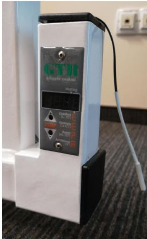
Sonda wychodząca z sterownika elektronicznego
